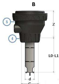
Trasmettitore di flusso Paddlewheel flow transmitter
